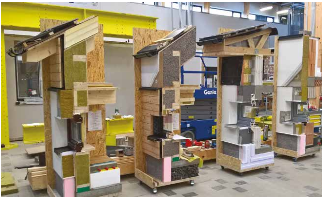
Obr. 1 Modely stavebných konštrukcií používané na školenia remeselníkov o požiadavkách na energetickú hospodárnosť budov.
